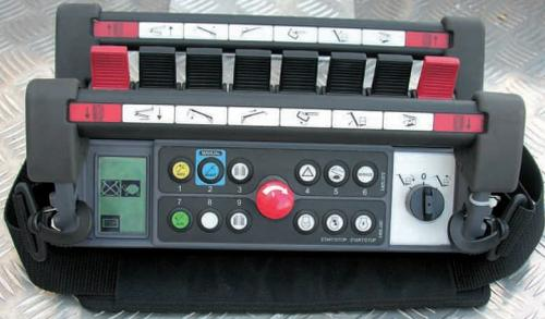
Die Steuerung der Abstützautomatik, Armbewegung und Raupen-Fortbewegung wird einfach und bequem über die PERFORMANCE III S - Fernbedienung ausgeführt. Ein praktisches Display liefert dem Bediener wichtige Informationen. Zusätzlich wurde das System um neue Parameter erweitert. Über das Download-Symbol kann die jeweils letzte für die Maschine verfügbare Softwareversion über das integrierte Modem direkt vom Bediener heruntergeladen werden.
