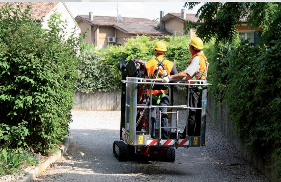
Über das innovative, in der Standardausstattung vorhandene Auto2Speed Antriebssystem wird eine Fahrgeschwindigkeit von bis zu max. 3,6 km/h erreicht, was doppelt so schnell ist wie die derzeit am Markt übliche Geschwindigkeit.
