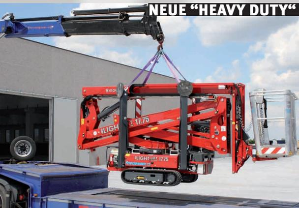
Es ist auch möglich, die Maschine mittels eines Krans an den dafür vorgesehenen neuen Ösen auf Transportfahrzeuge auf- und von diesen wieder abzuladen.
